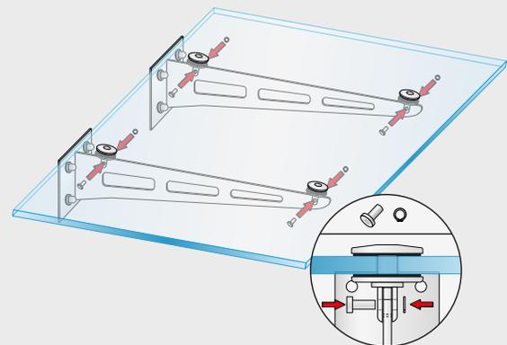
Sichern Sie die Punkthalter mithilfe der Bolzen und Sicherungsringe.
