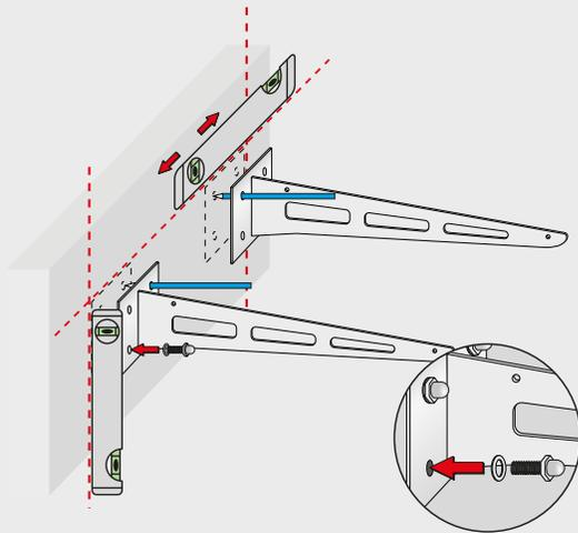
Richten Sie die Unterkonstruktion aus. Montieren Sie die Schwerter an die Unterkonstruktion bzw. den Baukörper.
