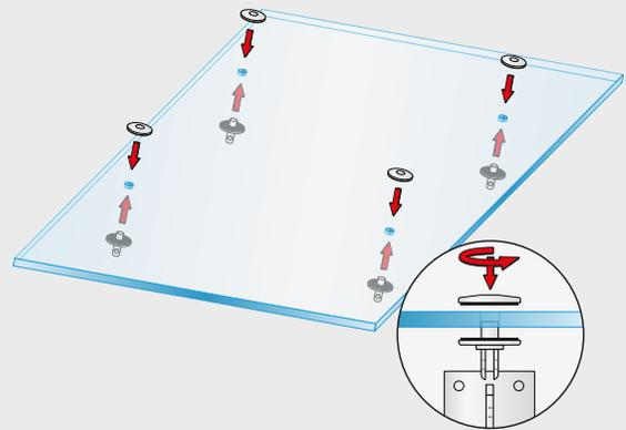
Verschrauben Sie die Punkthalter mit dem Auflager durch die Glasbohrungen der Scheibe und richten Sie diese parallel zu den Schwertern aus. Sichern Sie zuvor die Auflager mit flüssigem Schraubenkleber dauerhaft (z. B. Loctite).
