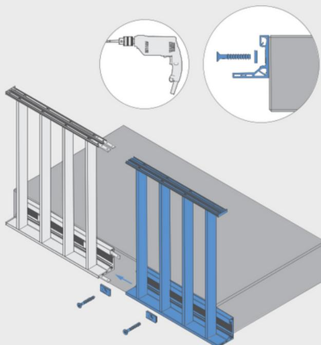
**5** Weiteres Modul zusammenstecken. Modul mit Klemmplatten und geeigneten Befestigungsmitteln am Baukörper befestigen.
