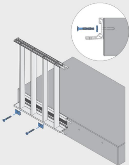
**4** Modul mit Klemmplatten und geeigneten Befestigungsmitteln am Baukörper befestigen.
