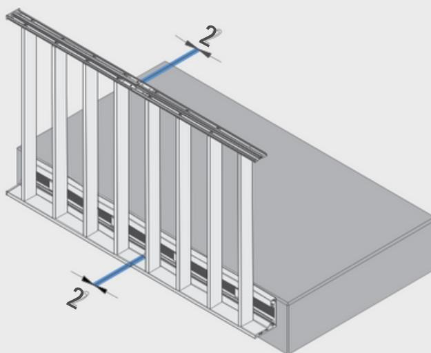
**6** Bei der Montage ist eine Dehnfuge von ca. 2mm zwischen den Modulen vorzusehen.
